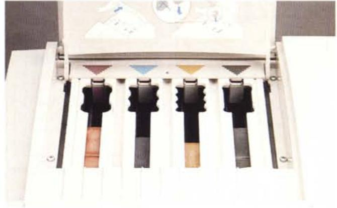
Il menu di stampa mediante il plug-in Export PhaserPrint da Adobe Photoshop. Qui sopra il vano per l'introduzione dei ColorStix.
