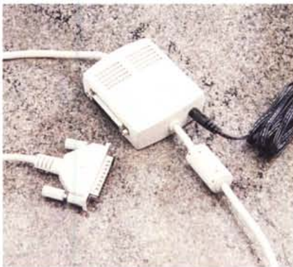
Lo scanner viene collegato al computer con un cordone che termina con uno scatolotto. Sullo stesso c'è il duplicatore di porta parallela ed il connettore. Nella foto in basso si può vedere la finestra di digitalizzazione.
