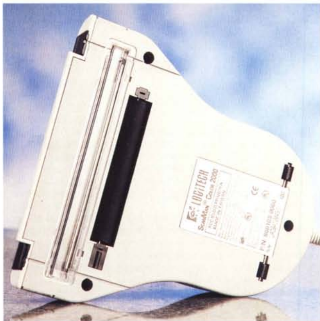
Lo scanner viene collegato al computer con un cordone che termina con uno scatolotto. Sullo stesso c'è il duplicatore di porta parallela ed il connettore. Nella foto in basso si può vedere la finestra di digitalizzazione.
