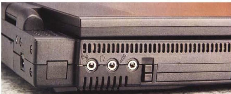
*Sul retro del portatile e sul suo lato sinistro troviamo le varie connessioni per i dispositivi esterni e l'alloggiamento per le schede PCMCIA di tipo I, II e III.*
