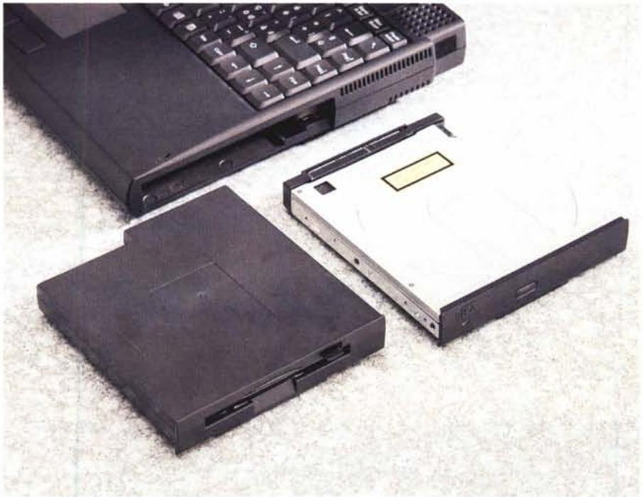
*Il lettore di CD-ROM (disponibile sia a velocità 8x che 10x) si inserisce in sostituzione dell'unità floppy disk. Quest'ultima è collegabile esternamente tramite porta parallela. In basso, l'alloggiamento per l'hard disk removibile e la sede del microprocessore (notare la ventola d'aerazione).*
