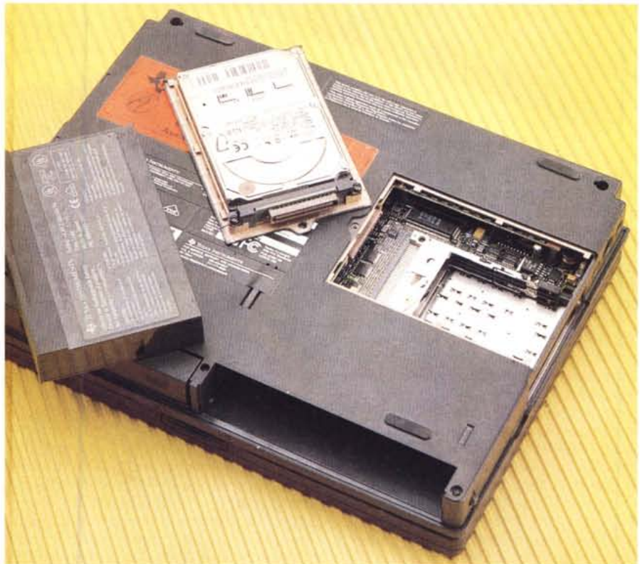
Come in molti portatili multimediali recenti, il lettore di CD-ROM si installa al posto dell'unità floppy disk. L'hard disk è accessibile dal fondo del notebook.
