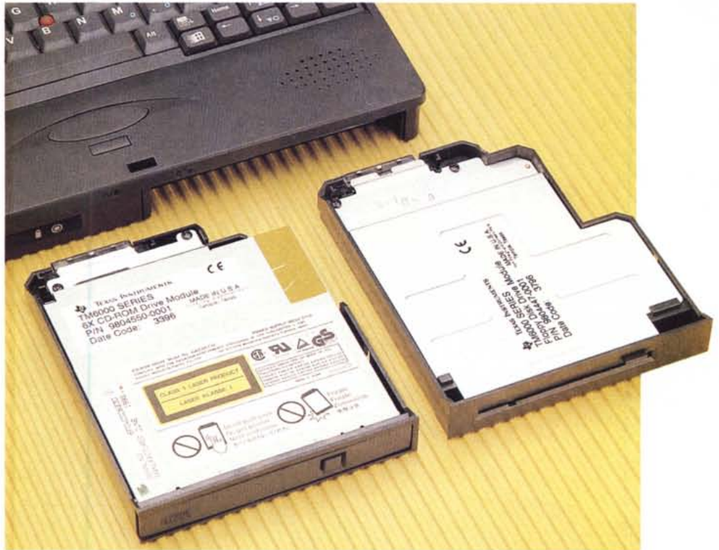
Come in molti portatili multimediali recenti, il lettore di CD-ROM si installa al posto dell'unità floppy disk. L'hard disk è accessibile dal fondo del notebook.
