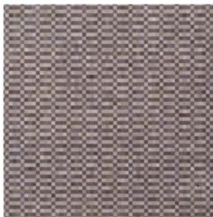
Ripresa dei colori campione. In modalità monocromatica (vedi testo) le immagini a colori risultano "puntinate", come visibile nell'ingrandimento estremo qui a lato che rappresenta un minuscolo settore del campione giallo.
