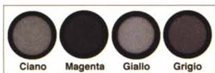
Ripresa dei colori campione. In modalità monocromatica (vedi testo) le immagini a colori risultano "puntinate", come visibile nell'ingrandimento estremo qui a lato che rappresenta un minuscolo settore del campione giallo.
