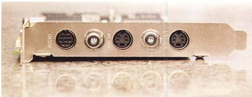
Sulla scheda sono disponibili i connettori audio e video per il collegamento diretto di altre schede senza la necessità di impiegare i connettori esterni. Nella foto della scheda sono riconoscibili i chip di codifica e decodifica video (in prossimità delle connessioni esterne) oltre al chip di codifica JPEG Zoran.
