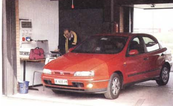
Durante una «sosta ai box», l'Ing. Filippo M. Vecchiotti, vicedirettore del Centro Prove, trasferisce i dati prestazionali rilevati dal Correvit al notebook Texas via interfaccia seriale. Quel portatile, infatti, non dispone di alloggiamento per schede PCMCIA.
