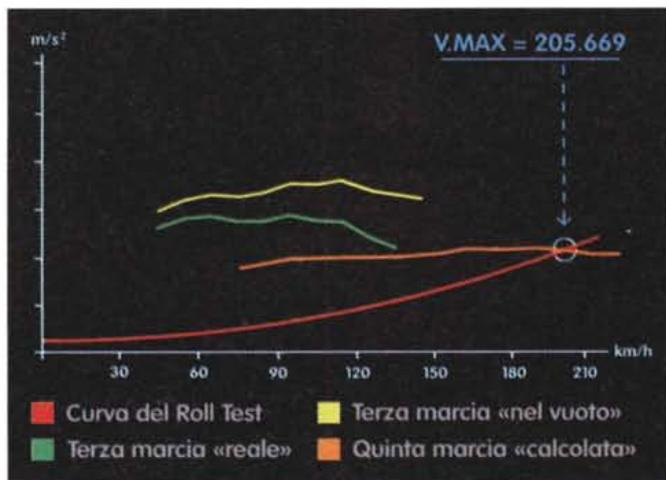
Per le macchine molto veloci è stato messo a punto un procedimento per calcolare, sempre con assoluto rigore scientifico, la velocità massima anche senza raggiungerla realmente (vedi testo).
