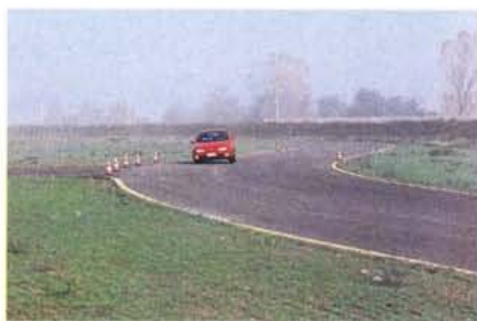
La pista di handling è utilizzata per testare il comportamento in curva e la guidabilità delle vetture provate.
