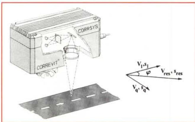
Il CORRSYS Correvit è un sistema di registrazione dei parametri prestazionali utilizzato per effettuare test su qualsiasi mezzo di locomozione. È utilizzato dal team di QUATTORUOTE per le sue prove su strada e praticamente da tutte le case automobilistiche.
