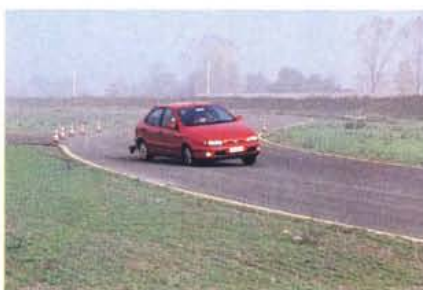
La pista di handling è utilizzata per testare il comportamento in curva e la guidabilità delle vetture provate.
