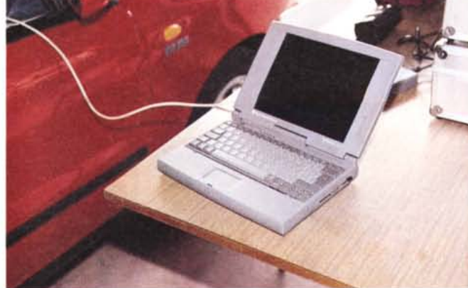
Durante una «sosta ai box», l'Ing. Filippo M. Vecchiotti, vicedirettore del Centro Prove, trasferisce i dati prestazionali rilevati dal Correvit al notebook Texas via interfaccia seriale. Quel portatile, infatti, non dispone di alloggiamento per schede PCMCIA.
