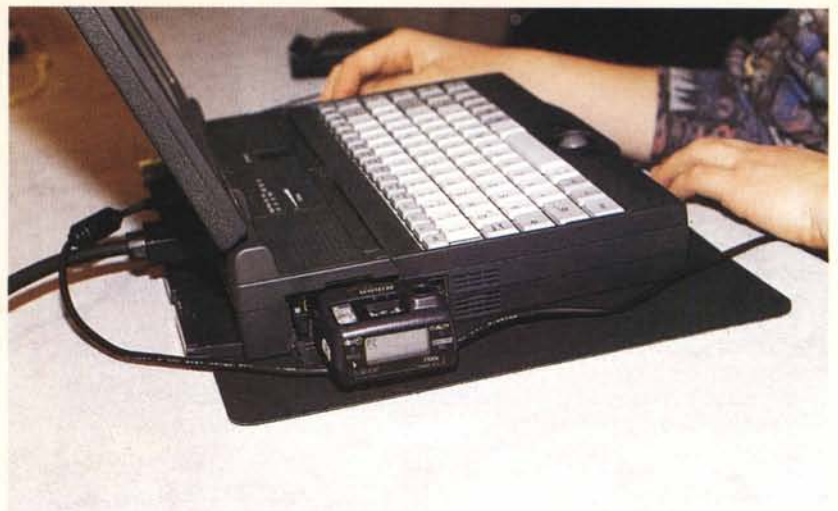
La Nikon CoolPix 100 si inserisce nei portatili come una normale scheda PCMCIA.
