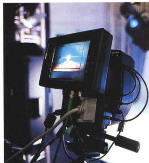
Sul dorso digitale Sinar è possibile installare un display a colori LCD.
