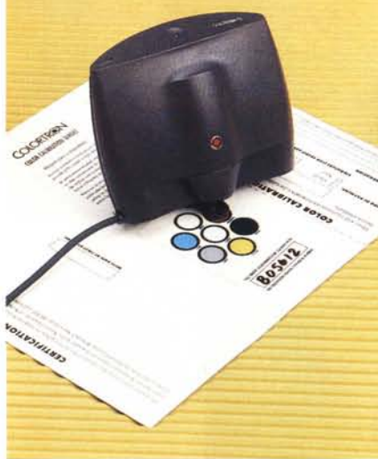
Il Colortron Color System durante la fase di test. A destra la scheda, con i colori campione, fornita a corredo e personalizzata per ogni apparecchio.
