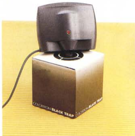
La taratura del nero avviene attraverso la «Black Trap Box» fornita a corredo. È necessario effettuare la taratura ad intervalli di tempo definibili dall'utente.
