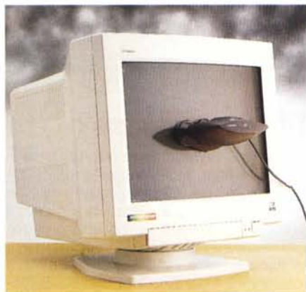
Per calibrare un monitor si utilizza l'apposito adattatore dotato di speciali ventose. Il software di gestione genera automaticamente il profilo ColorSync 2.
