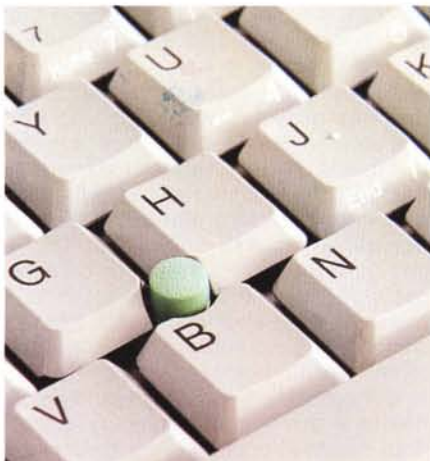
Il dispositivo di puntamento è l'ormai noto MousePoint inventato da IBM. A destra la tastiera, completa e ben funzionante.
