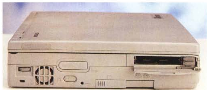
Vista frontale, laterale e posteriore del Tecra 500. Il grosso connettore in alto è utilizzato per il collegamento alla Card Station opzionale (vedi testo).
