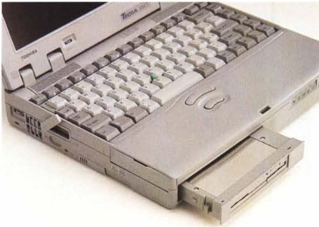
L'unità floppy disk, all'occorrenza, può essere sostituita da un lettore CD-ROM.
