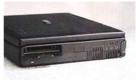
Il lettore di CD-ROM, le due slot PCMCIA e le tre prese jack per l'audio.
