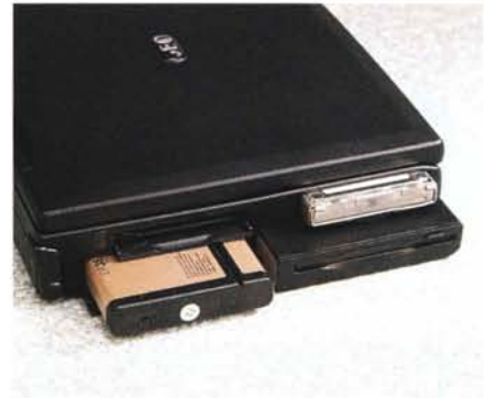
Particolare della batteria, dell'hard disk, del floppy e della slot PCMCIA ZV Port.
