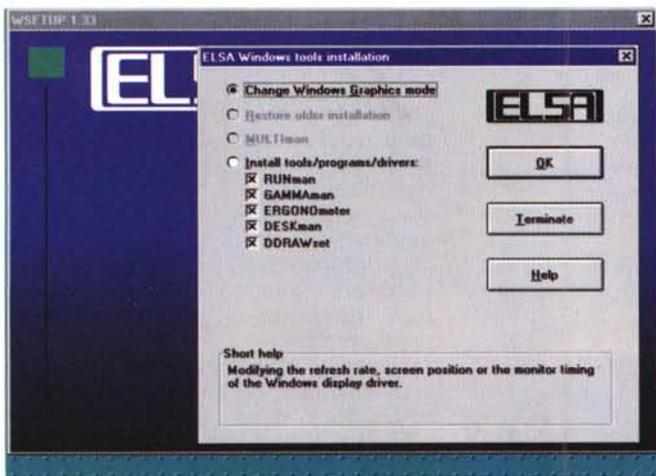
*L'installazione software della Elsa Victory 3D, nelle sue componenti aggiunte, avviene in questo requester, dove si potranno scegliere le utility da installare.*
