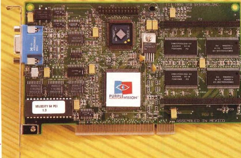
L'ottima realizzazione della sofisticata Purple Vision Velocity 64 è in evidenza nella foto; si riconoscono l'S3 Vision 968, etichettato, ed il potente RAMDAC IBM 9314, con clock a 220 MHz. In ultimo, sono presenti diversi connettori per le opzioni aggiuntive.
