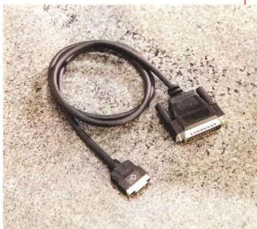
Il trasferimento delle immagini su computer avviene attraverso una porta SCSI «terminata»: la PDC-2000 può essere utilizzata solo come ultimo elemento della catena di dispositivi.
