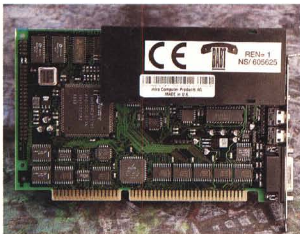
In primo piano la affollata realizzazione della miroMEDIA Online, scheda combinata fax/modem e audio; si notano sia l'incombente Mwave IBM (DSP 2780), sia la piggy-back a cavallo della stessa, dedicata alle funzioni di telecomunicazione.
