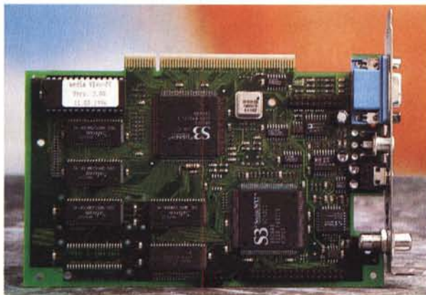
L'ottima fattura della miroMEDIA View è in evidenza: si notano sia il Trio 64 V+, chip molto ben conosciuto, che il nuovissimo Scenic MX/2, decoder MPEG della stessa S3.
