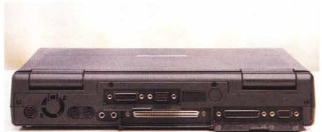
*Sul lato anteriore si «affacciano», ergonomicamente, le due unità per CD-ROM e floppy disk. Sul retro troviamo le numerose connessioni verso il mondo esterno: si noti a sinistra la silenziosa ventola d'aerazione termoattiva, al centro il grosso connettore per la docking station PCI opzionale.*
