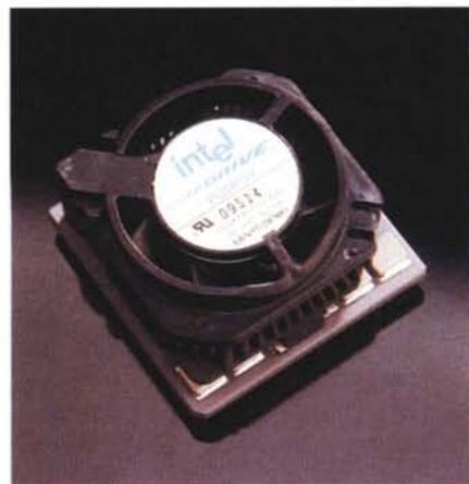
Si tratta di un processore Pentium vero e proprio adattato all'uso sulle schede madri 486, quindi con bus a 32 bit e riduttore per la tensione di alimentazione. In pratica può essere usato su tutte le motherboard con zoccolo predisposto senza alcuna difficoltà seguendo le istruzioni riportate nell'ampio manuale a corredo.
