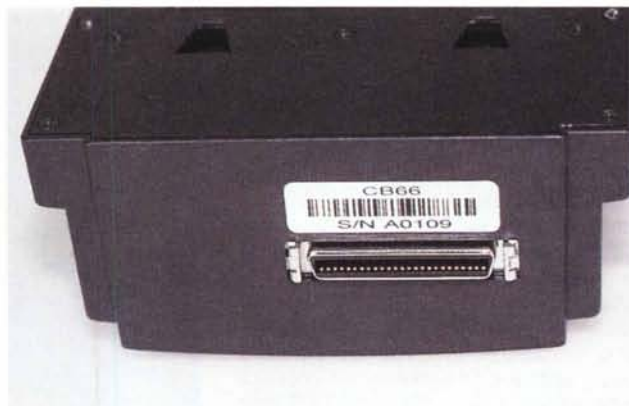
Il collegamento con il Camera Computer avviene tramite questa connessione.
