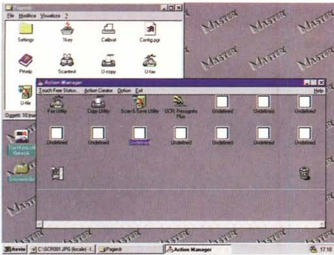
L'action Manager con cui è possibile associare ad un singolo bottone un'intera operazione con lo scanner.
