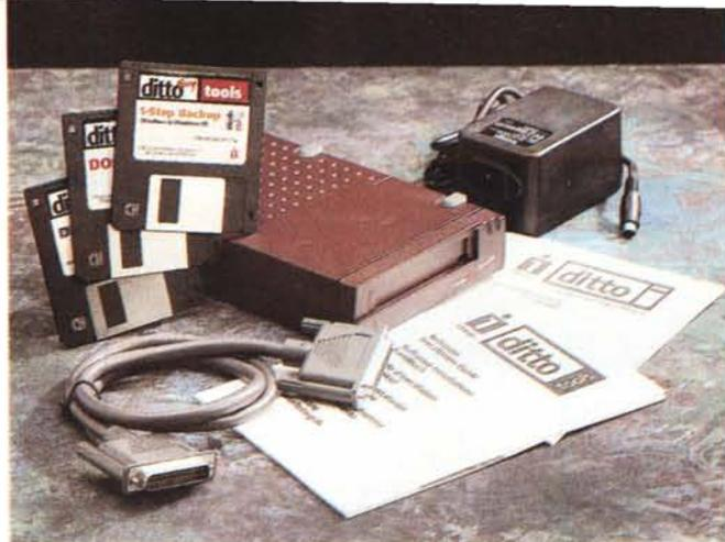
Il Ditto è il dispositivo di impostazione più tradizionale. Anche per esso è presente un completo software di gestione in grado di privilegiare le doti di sicurezza e/o di velocità nel trasferimento dei dati.
