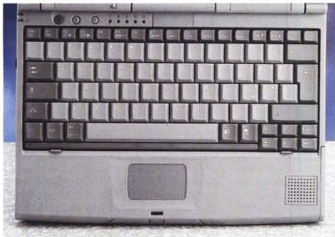
Per recuperare spazio prezioso sulla tastiera ed offrire un altrettanto comodo appoggio alle palme delle mani, si è deciso di spostare i tasti del TouchPad sulla parte esterna del computer.
