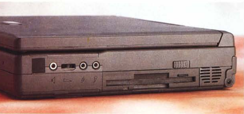
Sul lato destro troviamo gli ingressi e le uscite audio. Sul retro tutte le altre connessioni per il «mondo esterno».
