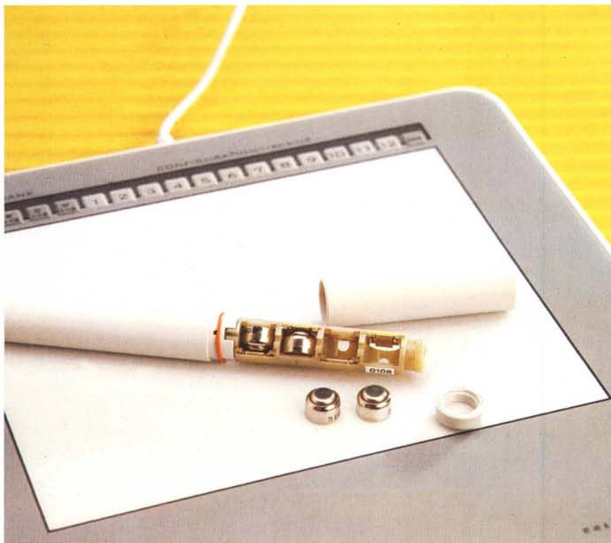
Lo stilo (o penna) della DrawingSlate II è alimentato da due batterie all'ossido d'argento; per impieghi gravosi possono essere montate quattro batterie.
