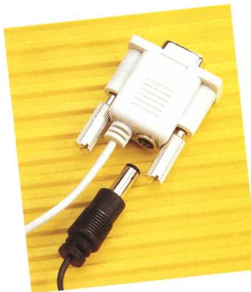
Il connettore che consente il collegamento alla porta RS232 offre anche la presa per l'alimentazione dalla tensione di rete. A destra, la tavoletta in condizioni operative, si noti il pratico portapenna per la corretta attivazione della funzione sleep.
