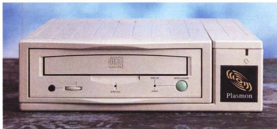
▲ Il frontale del CDR4220 è caratterizzato dal tasto turchese di azionamento del cassetto estraibile dell'unità (di produzione Philips).
