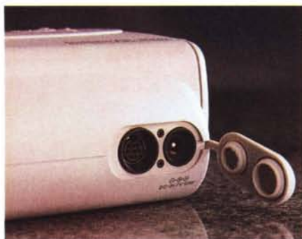
La porta seriale e la presa per l'alimentazione esterna.
