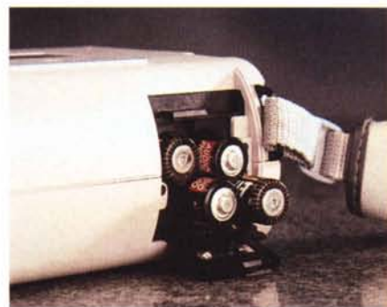
Quattro pile stilo alimentano la fotocamera.
