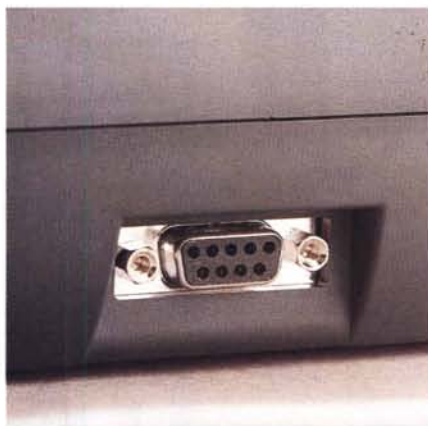
In alto il connettore DB9 per il collegamento al computer. A lato i due pulsanti per pilotare le funzioni dello scanner. In basso, l'ingresso per gli originali può essere sollevato per recuperare fogli inceppati.
