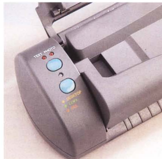
In alto il connettore DB9 per il collegamento al computer. A lato i due pulsanti per pilotare le funzioni dello scanner. In basso, l'ingresso per gli originali può essere sollevato per recuperare fogli inceppati.
