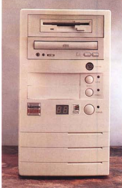
Vista «fronte/retro» della macchina. Notare la meccanica floppy disk alloggiata in una sede da 5 e 1/4.
