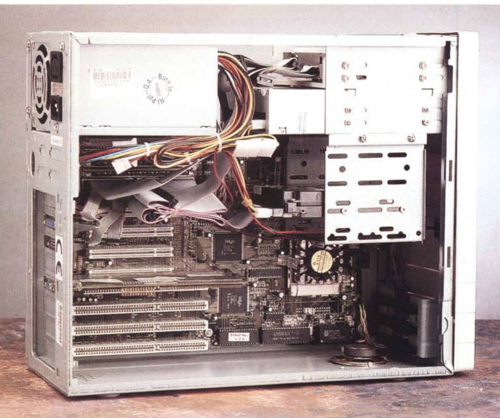
Il PC Master aperto. Notare i cavi tutti fissati tramite fascette e l'ottima accessibilità al processore.
