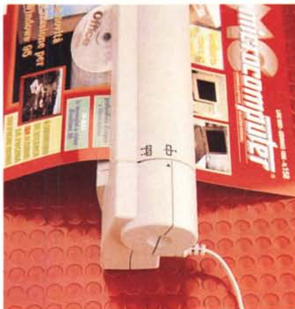
Ruotando il coperchio superiore è possibile modificare il percorso dei documenti da acquisire in relazione al loro spessore e consistenza.
