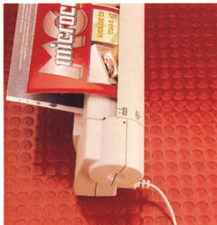
Ruotando il coperchio superiore è possibile modificare il percorso dei documenti da acquisire in relazione al loro spessore e consistenza.
