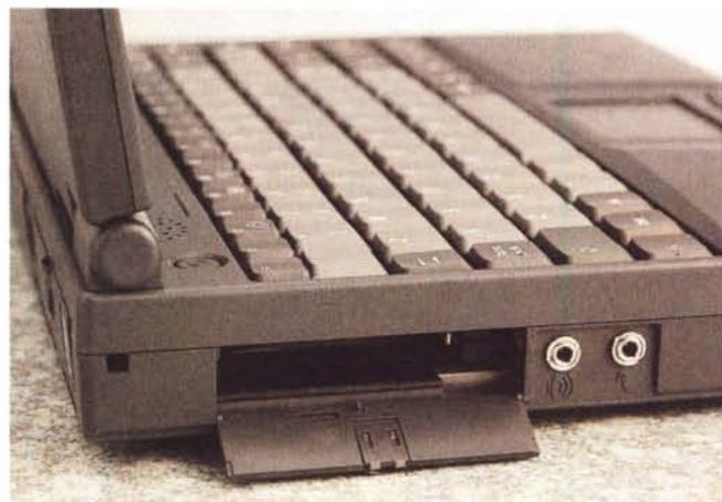
dio stereo a 16 bit. I due modelli sono totalmente compatibili con gli standard Sound Blaster e Windows Sound System e offrono inoltre la possibilità ulteriore di connettere un microfono e delle casse esterne.
