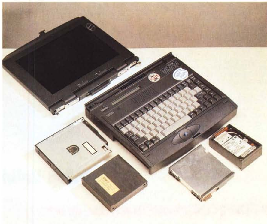
I notebook moderni sono modulari ed espandibili (nella foto il Pentimedia della VideoComputer).
