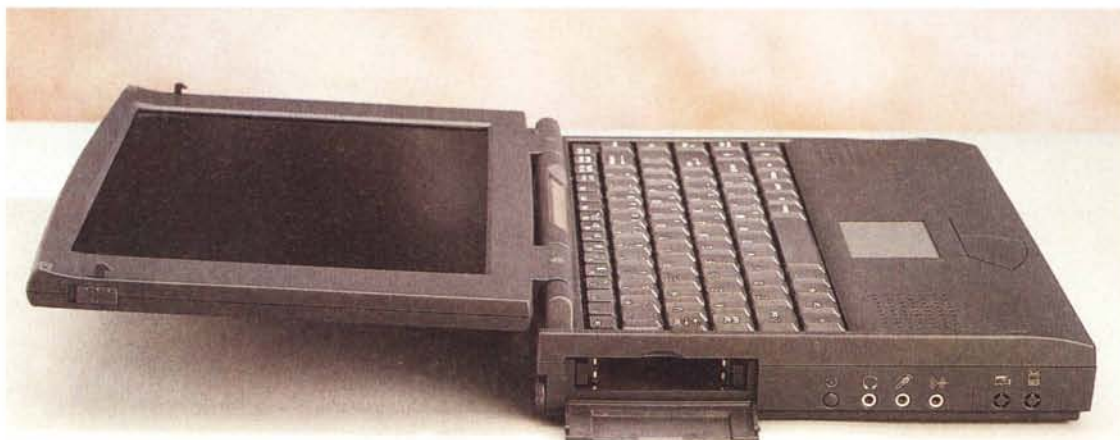
La parte destra conta per prima cosa uno sportello che cela gli slot per le schede PCMCIA. A lato dello sportello troviamo il pulsante di suspend e le varie uscite audio. Nella parte estrema ci sono serigrafate infine le porte di I/O per la scheda MPEG I opzionale.
