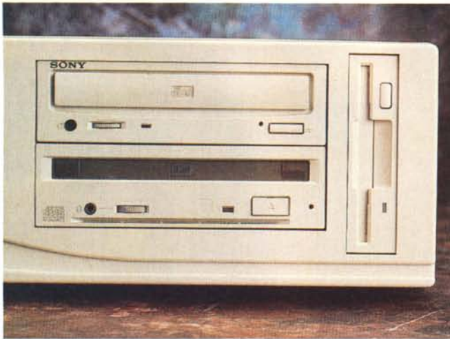
Due particolari, molto importanti ai fini dell'incisione CD-R, del computer utilizzato per i test: l'unità Sony di lettura e scrittura CD; l'adattatore SCSI Level 2 di produzione Adaptec.
