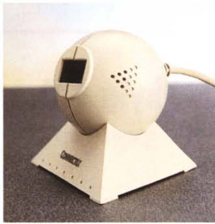
Sul lato destro è presente il microfono mono integrato.
