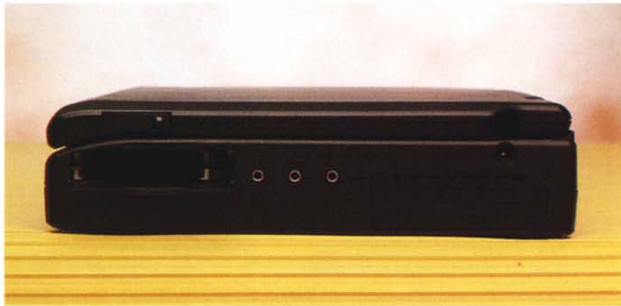
Sul lato sinistro troviamo una porta MIDI/Game, sul lato opposto ingressi e uscite audio, alloggiamento per schede PCMCIA di tipo III e batteria ricaricabile.
