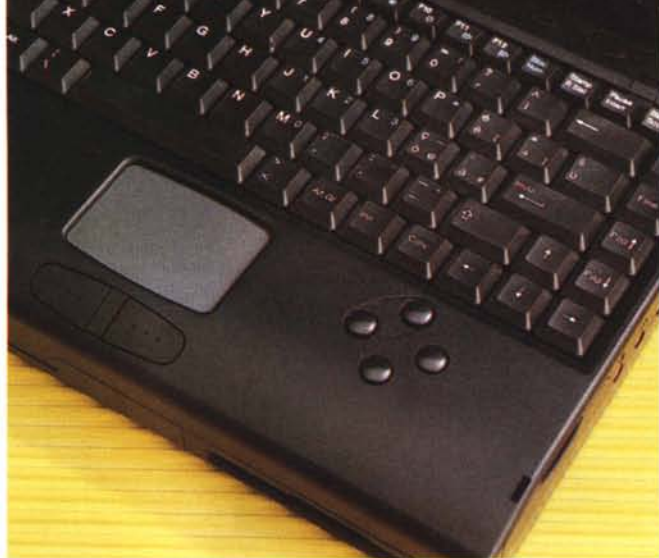
Sul retro del notebook le connessioni per il mondo esterno. A lato la minitavoletta grafica utilizzata come dispositivo di puntamento.
