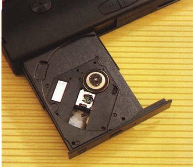
*Il lettore di CD-ROM integrato con il suo pick-up laser a «vista». Sia la parte ottica che il motore di rotazione sono incorporati nel cassetto porta CD. Anche per questa unità, la miniaturizzazione ha raggiunto livelli a dir poco eccezionali.*
