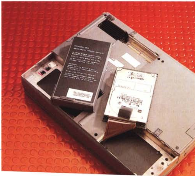
Sotto al portatile la sede per la batteria ricaricabile, per l'hard disk e per l'espansione di memoria. Il lettore di CD-ROM si affaccia sul lato sinistro.
