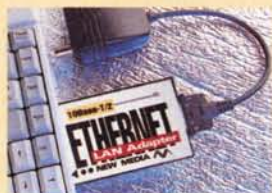
Ethernet Card Card di connessione di rete 10 Base T, 10 Base 2 e Combo. Tutte le card sono certificate Novell.
