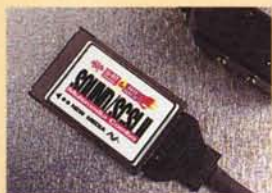
Sound Card Card stereo 16 bit, AdLib e Games compatibile. È disponibile anche la versione Combo con interfaccia SCSI.
