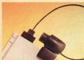
VVL Minicamera Telecamera B/N miniaturizzata alimentata direttamente dal portatile. È fornita con un flessibile kit di sviluppo.
