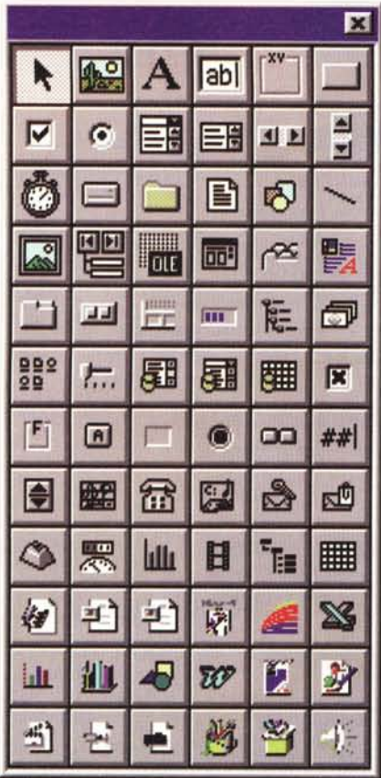
Figura 11 - MS Visual Basic 4.0 - Zoom sul Toolbox. In Visual Basic 4.0 è stato, come noto, abbandonato il concetto di VBX (file corrispondenti a librerie con Controls aggiuntivi specificamente realizzati per VB), ed è stato sostituito da quello, più generalizzato, di OCX. Il componente aggiuntivo è utilizzabile da qualsiasi linguaggio compatibile VBA e si comporta come piccola applicazione OLE (i componenti OCX si chiamano anche MiniOleServer). Qui vediamo uno zoom 2 per della ToolBox di Visual Basic 4.0 caricata con una serie di OCX in più rispetto a quelli standard. O perché non caricati dalla procedura standard di installazione o perché aggiunti da altri applicativi installati sul sistema.
