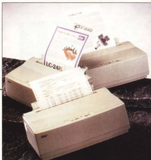
LC90 Stampante a 9 aghi, 80 colonne, velocità 192cps, inseritore 55 fogli
