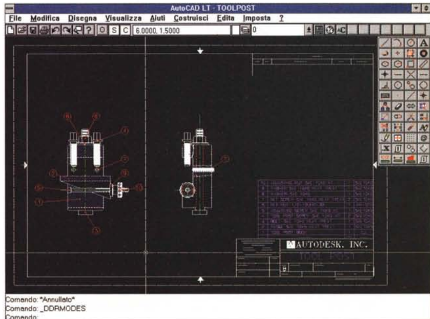
Figura 3 - Autodesk AutoCAD LT 2 - Lavoro su un foglio ANSI o ISO. AutoCAD LT 2 utilizza il concetto di Prototipo (Template). Consente quindi di iniziare un nuovo progetto partendo da un disegno già abbozzato. Nel materiale a disposizione sono presenti una serie di Prototipi che predispongono i fogli secondo le impostazioni standard americane (ANSI) ed europee (ISO). È stato introdotto anche il concetto di Blocco di Titoli, una specie di Timbro Virtuale. Si tratta di un comando che piazza sul disegno, nella posizione desiderata, data di sistema, nome del file e nome dell'utente.
