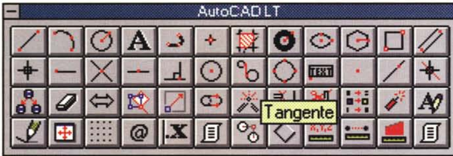
Figura 8 - Autodesk AutoCAD LT 2 - Il Riquadro degli Strumenti. Un generico comando può essere eseguito in tre modalità differenti. Ne può essere digitato il nome nella riga di comando posta in fondo nella videata, può essere scelto dal menu, può essere attivato dal pulsante presente nel riquadro degli strumenti. Per interrompere, in qualsiasi momento, l'esecuzione di un comando si digita Ctrl-C, oppure si pigia il pulsante corrispondente. Alcuni dei pulsanti servono per facilitare l'immissione delle coordinate.
