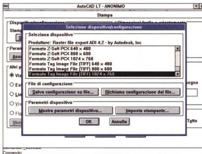
Figura 17 - Autodesk AutoCAD LT 2 - Selezione del dispositivo di uscita. Un disegno può essere salvato in formato DWG (compatibile con AutoCAD 12) oppure esportato nel formato DXF, di AutoCAD, o SLD, slide di AutoCAD, oppure WFM, metafile di Windows (in quest'ultimo caso di salva una vista bidimensionale del progetto). Si può anche salvare un'immagine Bitmap del disegno, o meglio della vista del disegno. La funzionalità relativa è accessibile dal comando di Stampa. I formati disponibili sono BMP, PCX, GIF e TIF, che sono come noto i quattro più importanti.
