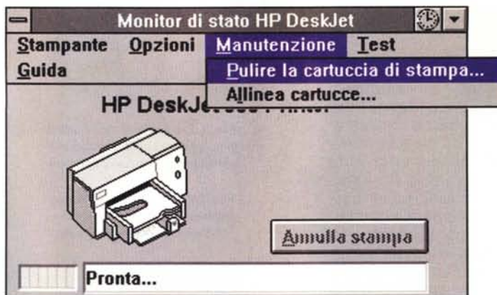
Il Deskjet Status Monitor (Monitor di Stato HP DeskJet) offre informazioni sullo stato della stampante e consente di eseguire normali operazioni di manutenzione come la pulizia degli ugelli.
