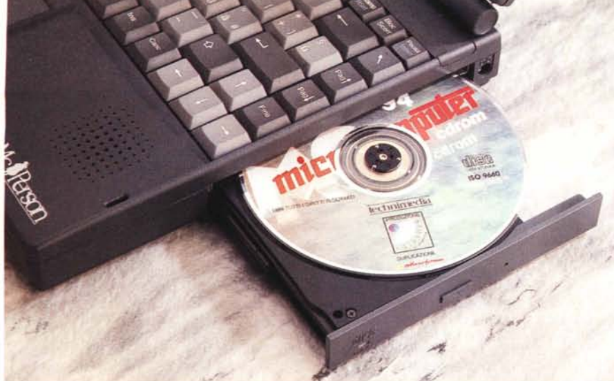
Il lettore di CD-ROM integrato. Motore e pick-up di lettura (foto a destra) sono incorporati nel carrello porta CD.
