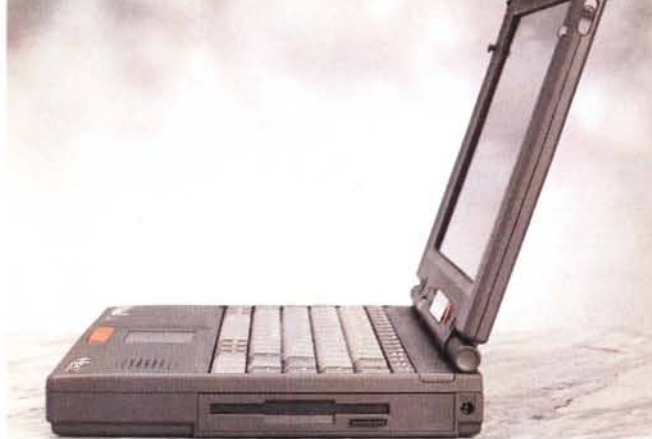
La meccanica per floppy disk del notebook Mistral può essere sostituita con un più multimediale lettore di CD-ROM. In basso a sinistra l'alloggiamento PCMCIA e la porta seriale, a destra le connessioni disponibili sul retro.
