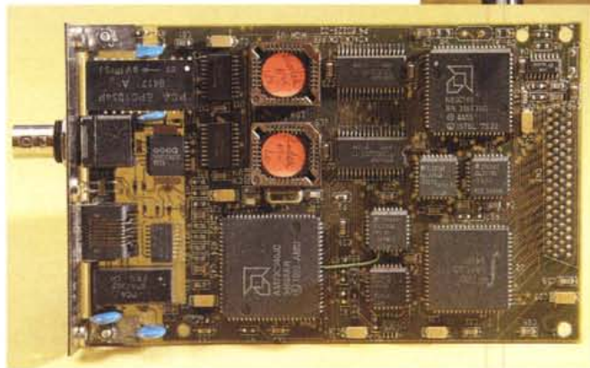
L'elettronica della Kodak XLS 8600 PS e, qui a lato, la scheda di rete opzionale. Si noti (nell'immagine in alto) i numerosi connettori SIMM per espandere la memoria RAM della macchina. Con più memoria aumenta la velocità di stampa, ma anche con la macchina in versione base i risultati sono comunque sorprendenti.
