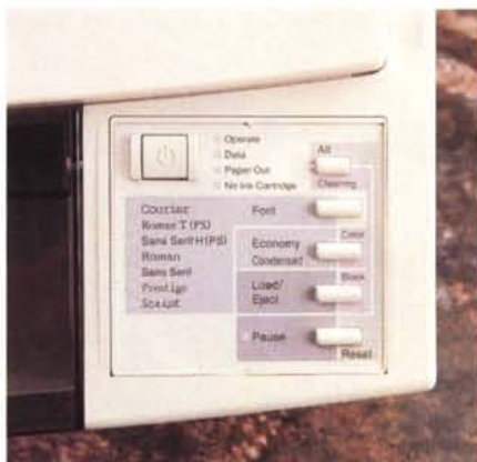
Le interfacce standard parallela Centronics e seriale RS422, il semplice pannello operativo ed una veduta laterale che mostra l'ingombro della stampante.
