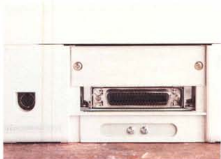
Le interfacce standard parallela Centronics e seriale RS422, il semplice pannello operativo ed una veduta laterale che mostra l'ingombro della stampante.
