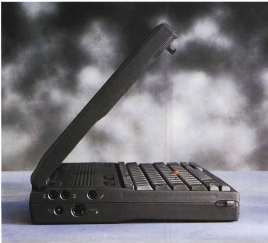
Le varie viste del notebook, dalle quali si possono notare le varie porte di interfaccia, sia come memorie di massa che di I/O audio. Tra le altre spicca la "finestra" dell'interfaccia SIR (ad infrarossi).
