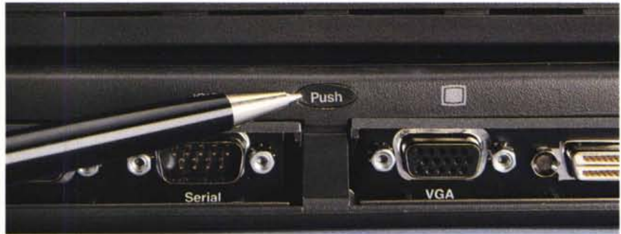
La novità è che l'apertura degli sportelletti è comandata meccanicamente da un pulsante così di evitare rotture o perdite degli stessi.
