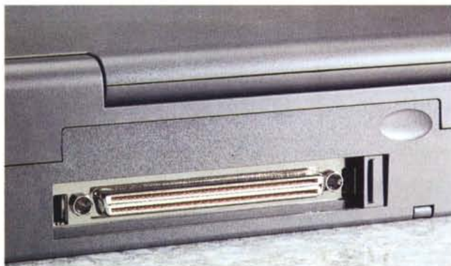
Per collegare il portatile alla docking station è sufficiente aprire questo piccolo sportellino scorrevole. Per accedere, invece, alle porte integrate si ribalta lo sportello posteriore (in basso).
