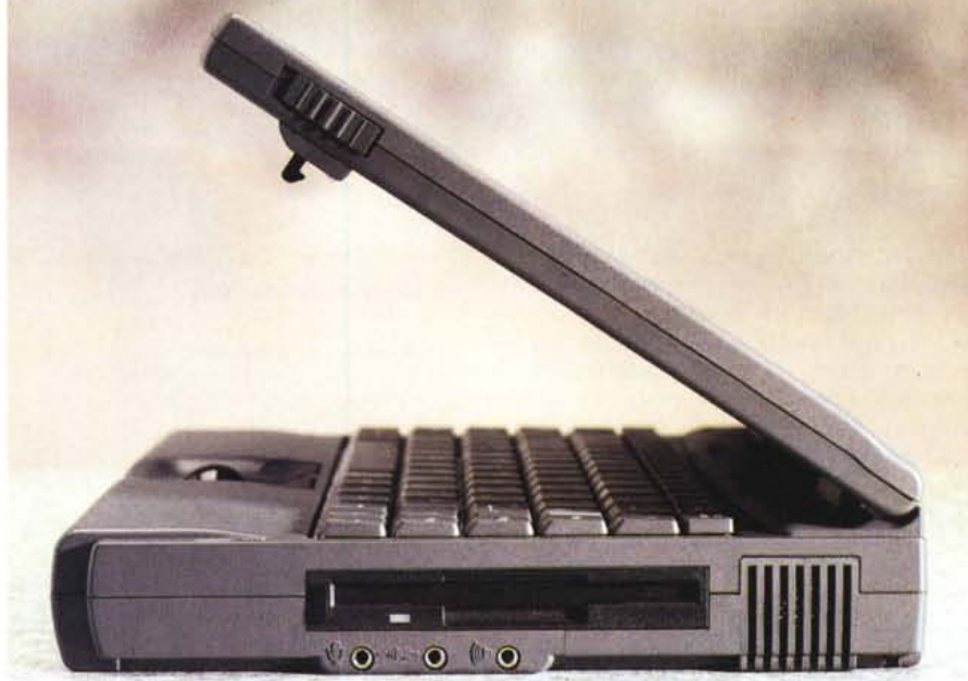
Sul lato destro della macchina il drive per floppy disk da 1.4 MB e la (silenziosa) ventola d'aerazione.
