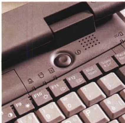
A sinistra l'interruttore di alimentazione più alcune spie, a destra la trackball integrata.
