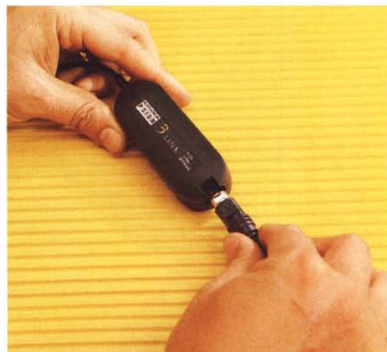
Il cavo di connessione è il medesimo del kit DOS 3 Link RS232, terminato da un lato con connettori DB9-DB25 e dall'altro con un miniDIN da inserire nella minuscola interfaccia da collegare al palmtop Psion.
