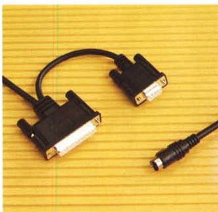
Il cavo di connessione è il medesimo del kit DOS 3 Link RS232, terminato da un lato con connettori DB9-DB25 e dall'altro con un miniDIN da inserire nella minuscola interfaccia da collegare al palmtop Psion.
