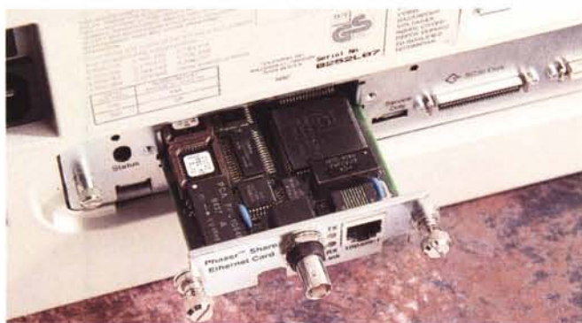
A sinistra la scheda elettronica estratta dalla sua sede. In alto la scheda Phaser Share (in versione Ethernet) per la condivisione in rete della stampante.
