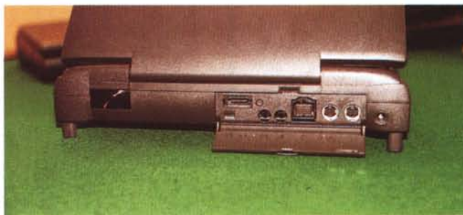
I nuovi PowerBook «all-in-one» sono più compatti e leggeri. Sul retro non troviamo più la porta Ethernet (comunque utilizzabile via scheda PCMCIA), ma una comoda interfaccia a raggi infrarossi di serie sui modelli di fascia alta.
