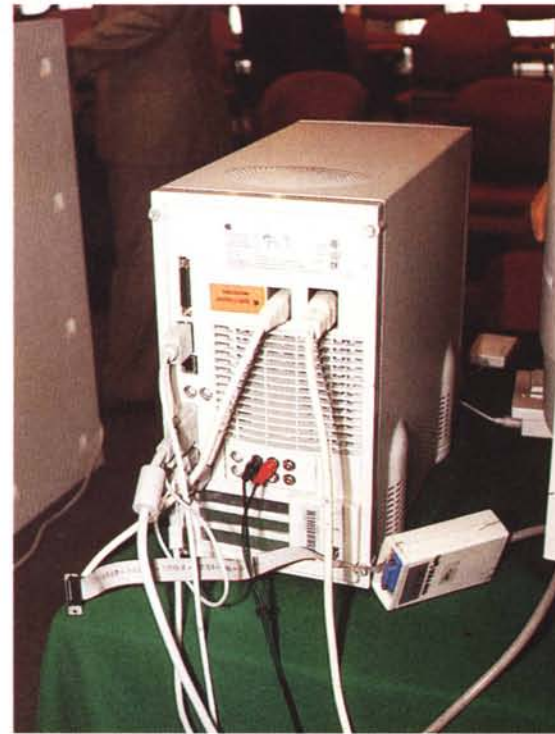
Sul retro dei nuovi Power Macintosh troviamo la predisposizione per le schede PCI. Nel modello 8500 troviamo anche ingressi e uscite video.
