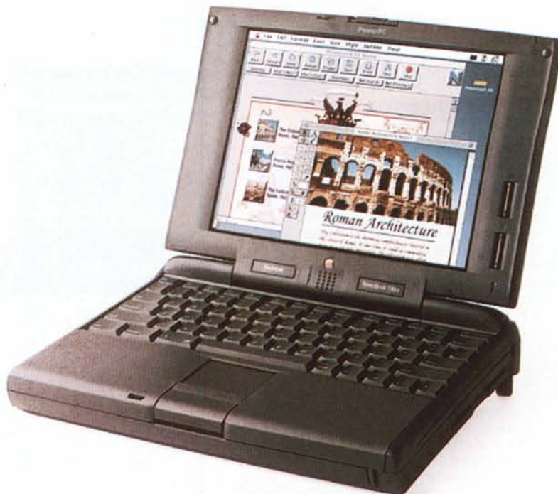
I nuovi PowerBook «all-in-one» sono più compatti e leggeri. Sul retro non troviamo più la porta Ethernet (comunque utilizzabile via scheda PCMCIA), ma una comoda interfaccia a raggi infrarossi di serie sui modelli di fascia alta.
