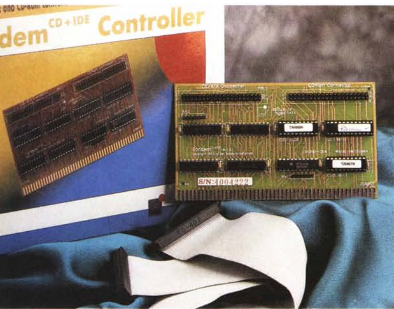
La scheda Tandem CD+IDE per A2000-3000-4000, una volta installata e configurata nel sistema, è pronta per accogliere drive ottici Mitsumi, Hard Disk ed unità Syquest in standard IDE.
