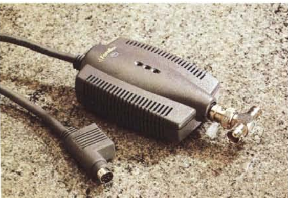
L'adattatore per il collegamento su reti EtherTalk e, a destra, lo scomodo alimentatore separato.
