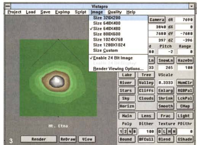
Foto 3 - Altro menu aperto è quello dedicato a Image, cioè alle dimensioni del nostro rendering (di base, da 320 x 200 a 1280 x 1024).
